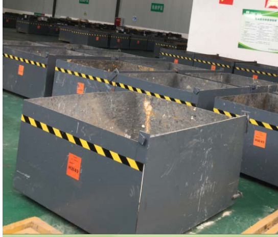
完整废电池贮存用铁槽（耐酸腐）示意图
